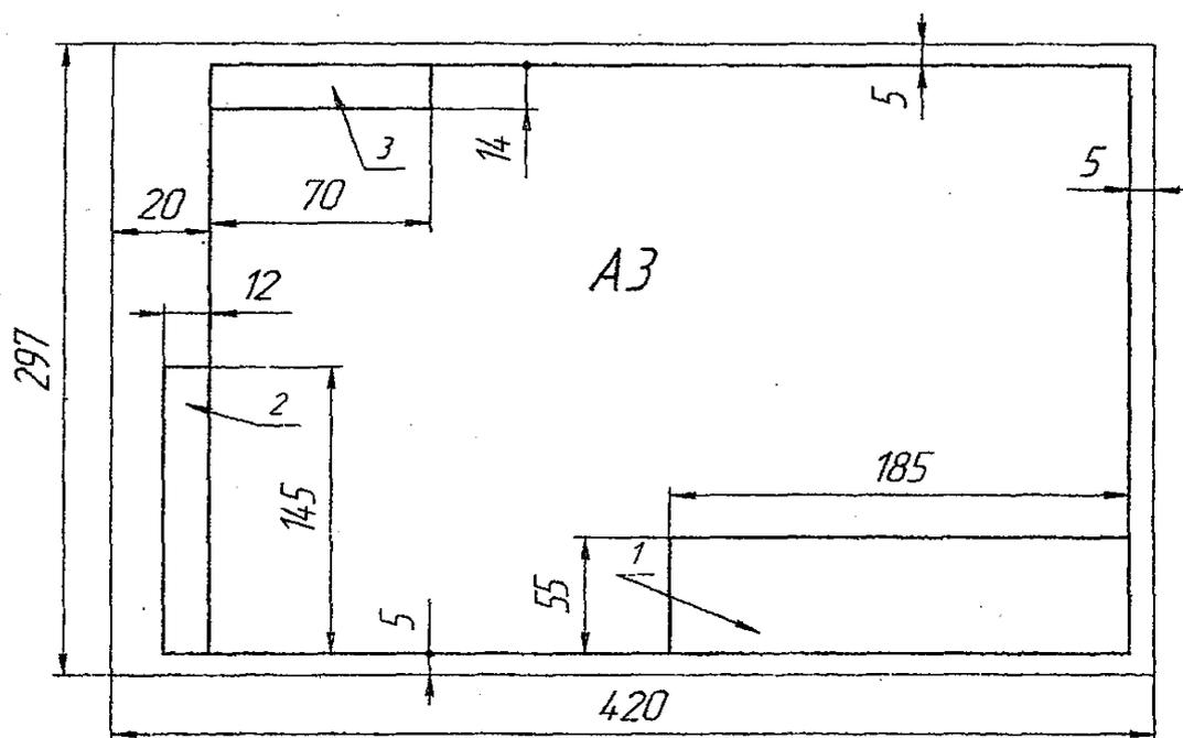
Рисунок 2 – Пример оформления формата А3 горизонтальной ориентации
