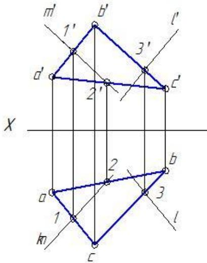
Рисунок 3.11 – Принадлежность прямой линии плоскости
