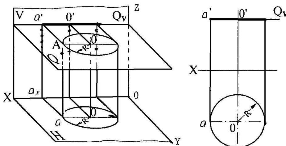
Рисунок 4.5 – Вращение вокруг горизонтально проецирующей оси, перпендикулярной плоскости  $H$
