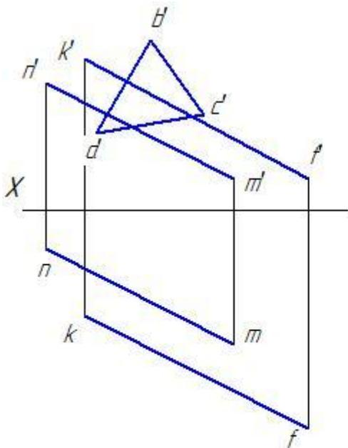
3.1 Достроить горизонтальную проекцию треугольника  $ABC$ , лежащего в плоскости, заданной параллельными прямыми  $MN$  и  $FK$ .
