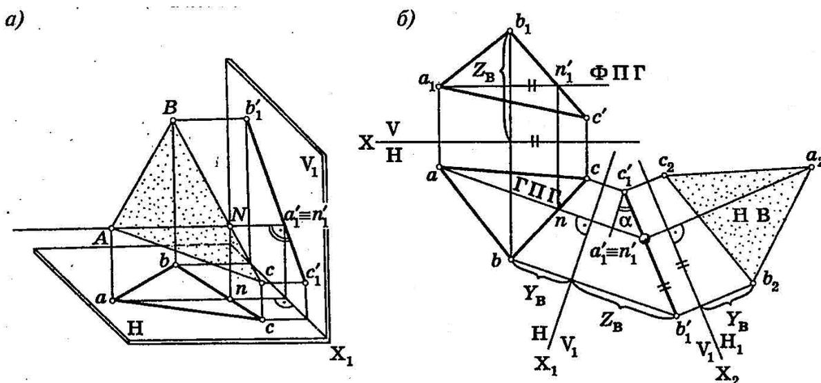
Рисунок 4.3 – Определение натуральной величины треугольника
