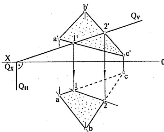
Рисунок 3.19 – Пример построения пересечения двух плоскостей, одна из которых проецирующая
