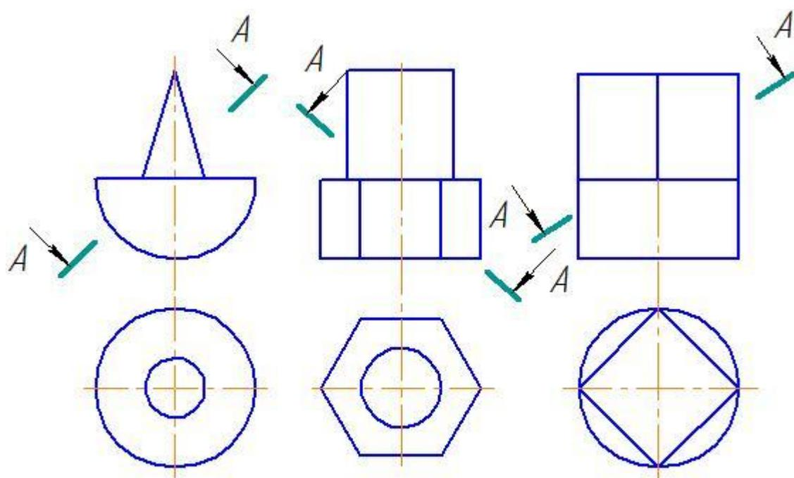
5.7 Построить три проекции линии сечения геометрических тел плоскостью  $A - A$
