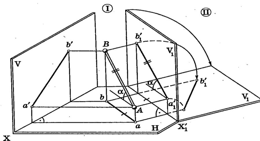
Рисунок 4.1 – Замена фронтальной плоскости проекций
