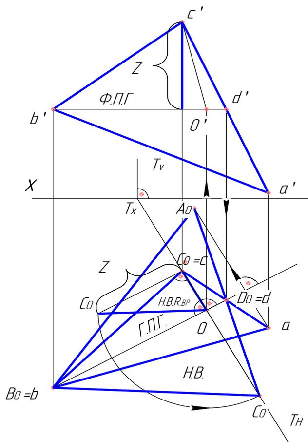
Рисунок 4.8 – Определение натуральной величины треугольника вращением его вокруг линии уровня
