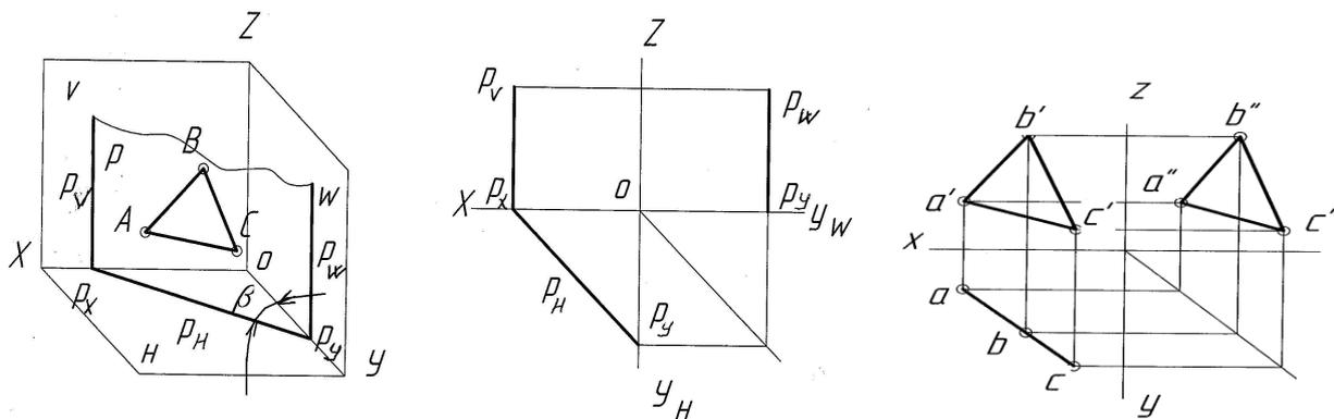
Рисунок 3.5 – Наглядное изображение и эюр горизонтально проецирующей плоскости
