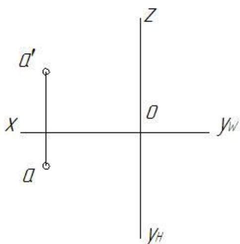
2.3 Через точку  $A$  провести горизонталь под углом  $60^\circ$  к  $W$  так, чтобы точка этой прямой  $B$  лежала на плоскости  $W$ .
