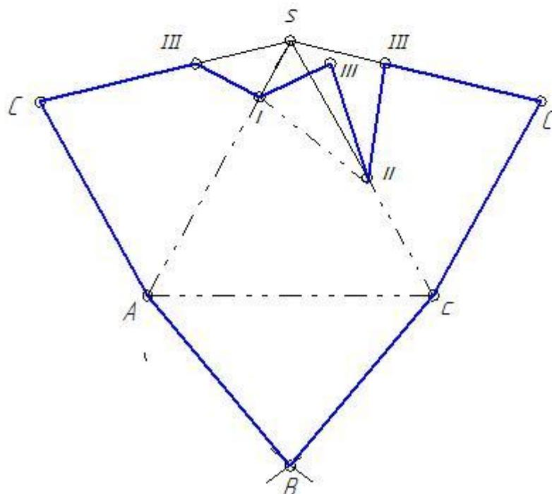
Рисунок 5.2 — Пример построения развертки нижней отсеченной части пирамиды
