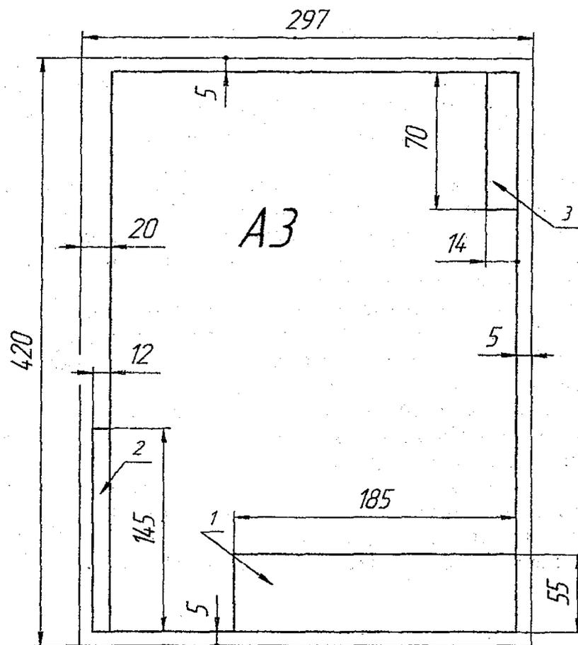
Рисунок 1 – Пример оформления формата А3 вертикальной ориентации
