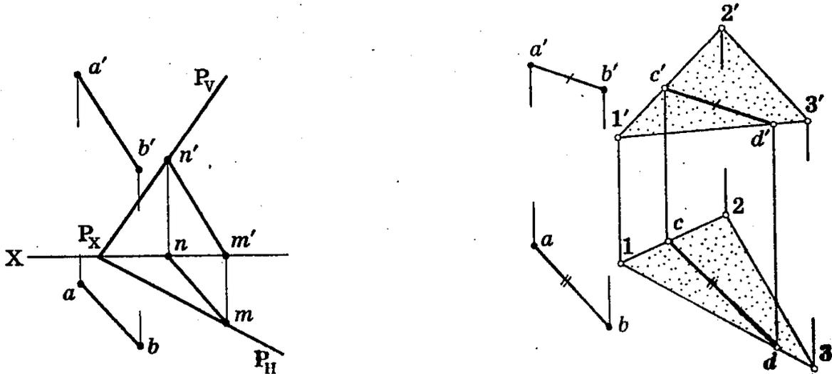
Рисунок 3.18 – Построение прямой, параллельной плоскости
