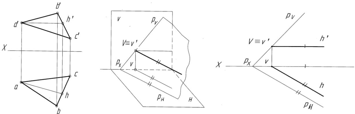
Рисунок 3.13 – Наглядное изображение и эпюр горизонтали плоскости общего положения
