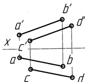
Рисунок 2.8 – Эпюр параллельных прямых
