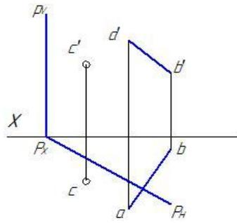
3.8 Построить линию пересечения плоскости  $P$  с плоскостью, заданной прямой  $AB$  и точкой  $C$ .
