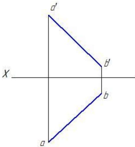
4.6 Способом вращения определить натуральную величину отрезка АВ и углы наклона к Н и V.
