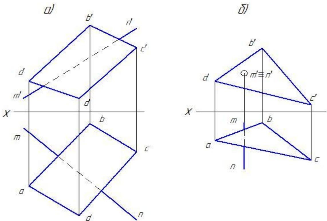
3.13 (а-б) Найти точки пересечения прямой  $MN$  с плоскостью и определить видимые части прямой.
