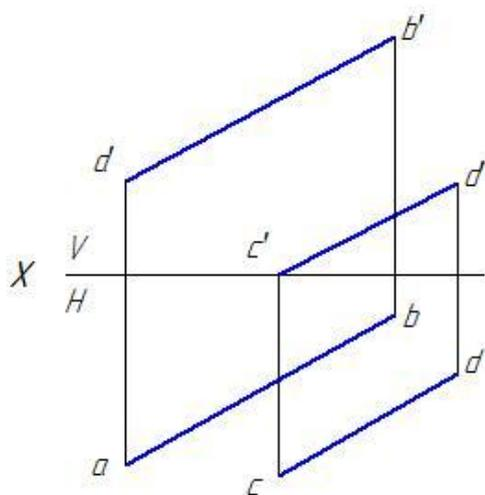
4.3 Определить расстояние между параллельными прямыми  $AB$  и  $CD$ .
