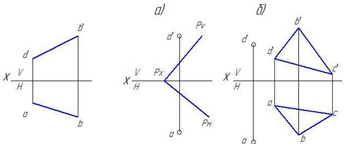
4.12 Определить истинную величину отрезка АВ способом плоскопараллельного перемещения.
