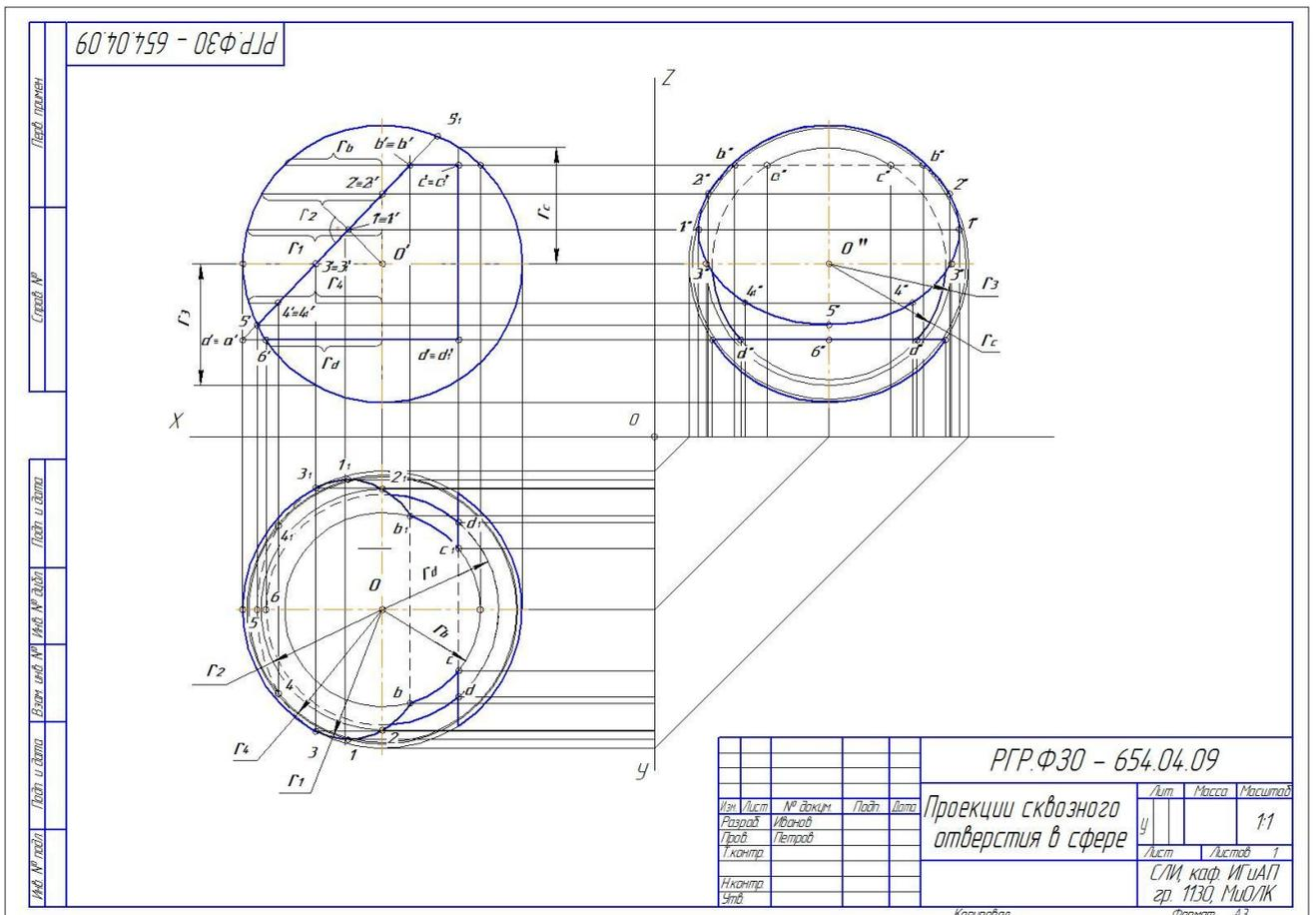
Рисунок 9 - Эпюр № 4. Проекция сквозного отверстия в сфере
