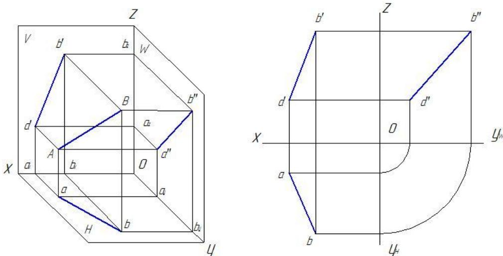
Рисунок 2.1 – Наглядное изображение прямой  $AB$  и построение ее проекций на эпюре
