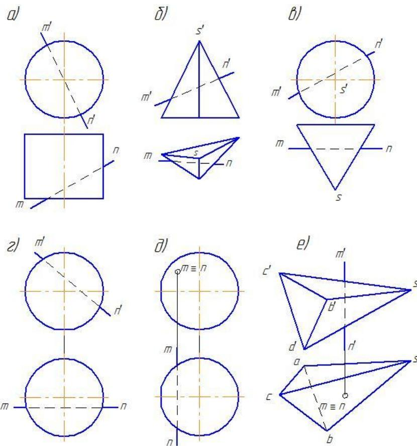
56 (а-е) Построить точки пересечения прямой с поверхностью тел, определить видимость элементов
