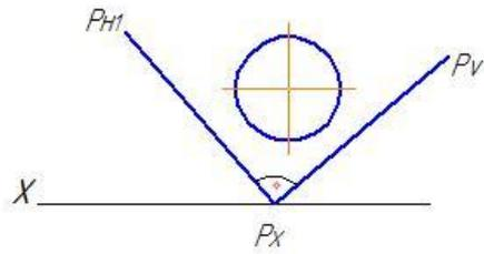
4.16 Дано совмещенное с плоскостью  $V$  положение окружности, лежащей в плоскости  $P$ . Построить ее проекции
