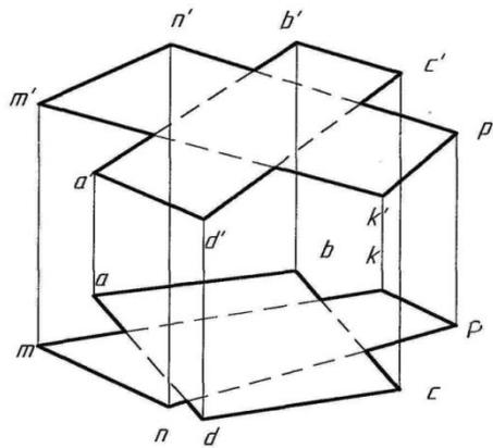
3.10 Построить линию пересечения двух плоскостей и определить видимость их частей на плоскостях  $H$  и  $V$
