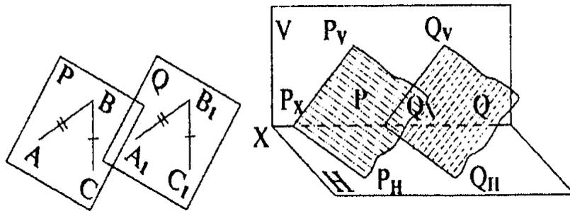
Рисунок 3.23 – Наглядный пример параллельных плоскостей
