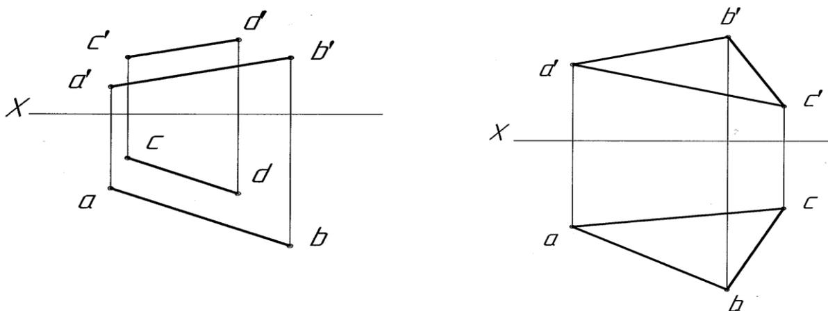
Рисунок 3.2 – Задание плоскости двумя параллельными прямыми и плоской фигурой
