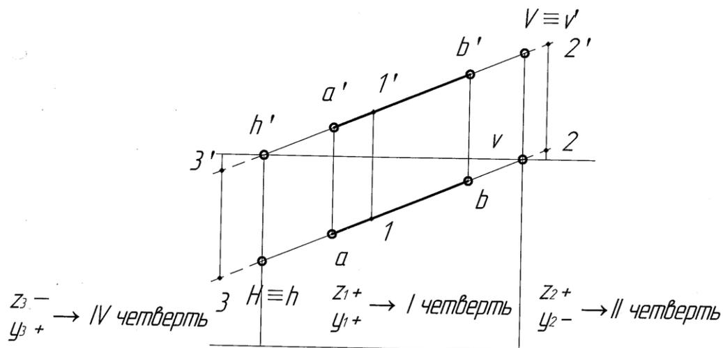
Рисунок 2.5 – Эпюр прямой линии общего положения  $AB$  и ее следов
