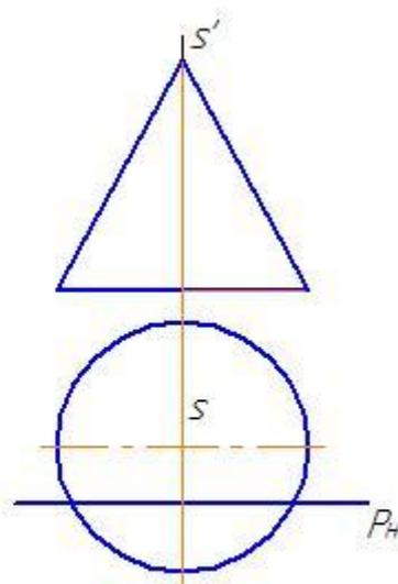
5.4 Построить проекции фигуры сечения конуса плоскостью  $P$
