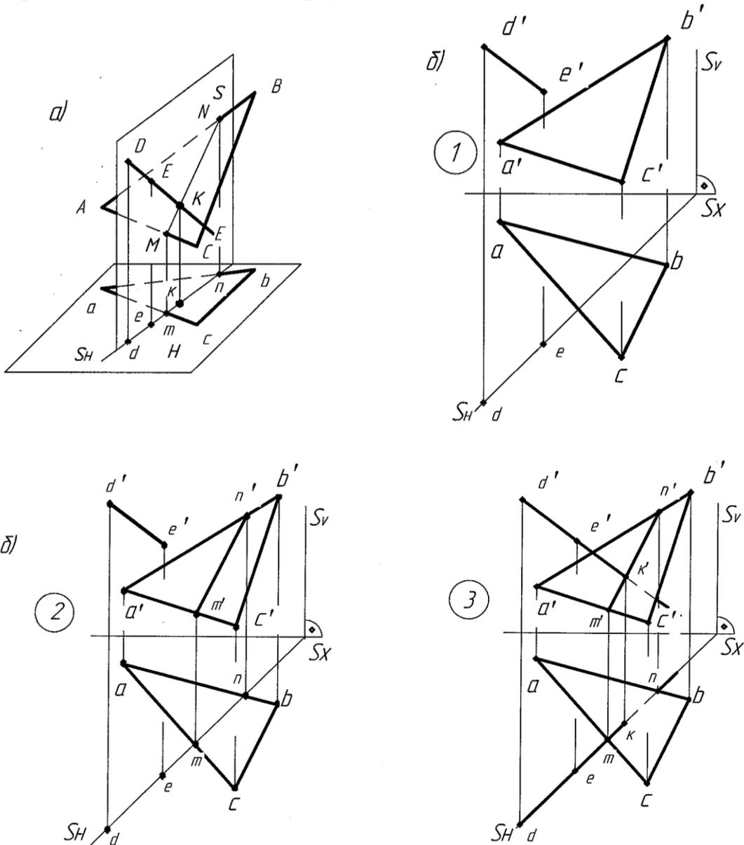
Рисунок 3.16 – Пересечение прямой с плоскостью
