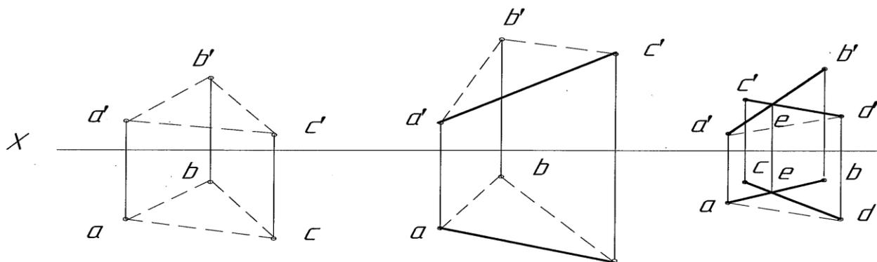
Рисунок 3.1 – Задание плоскости тремя точками, не лежащими на одной прямой; прямой и точкой, не лежащей на этой прямой; двумя пересекающимися прямыми
