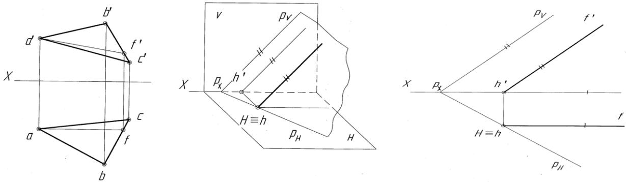
Рисунок 3.14 – Наглядное изображение и эпюр фронтали плоскости общего положения
