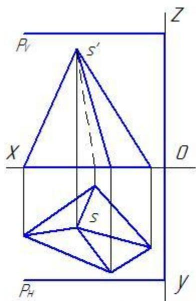
5.2 Построить проекции и натуральный вид фигуры сечения тела плоскостью  $P$
