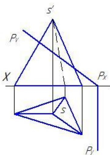
5.3 Построить проекции сечения пирамиды плоскостью  $P$ , определить НВ сечения и выполнить развертку нижней отсеченной части
