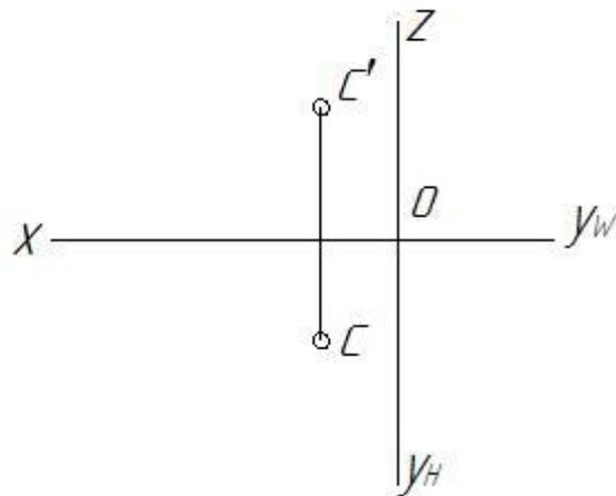
2.2 Через точку  $C$  провести фронтальную прямую под углом  $30^\circ$  к  $W$  и отложить на ней отрезок  $CO = 30$  мм
