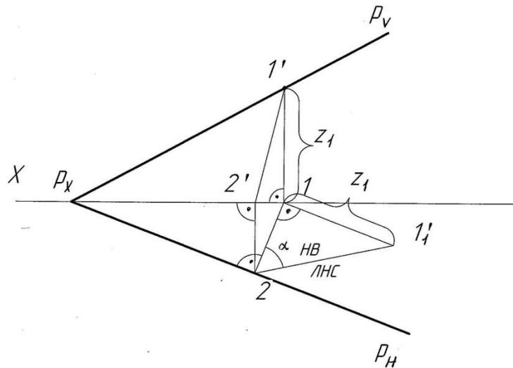
Рисунок 3.15 – Наглядное изображение линии наибольшего ската плоскости
