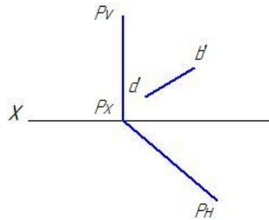
4.17 Даны плоскость  $P$  и лежащая в ней прямая  $AB$ . Построить в плоскости  $P$  прямую  $CD$ , параллельную  $AB$  на расстоянии 10 мм от нее
