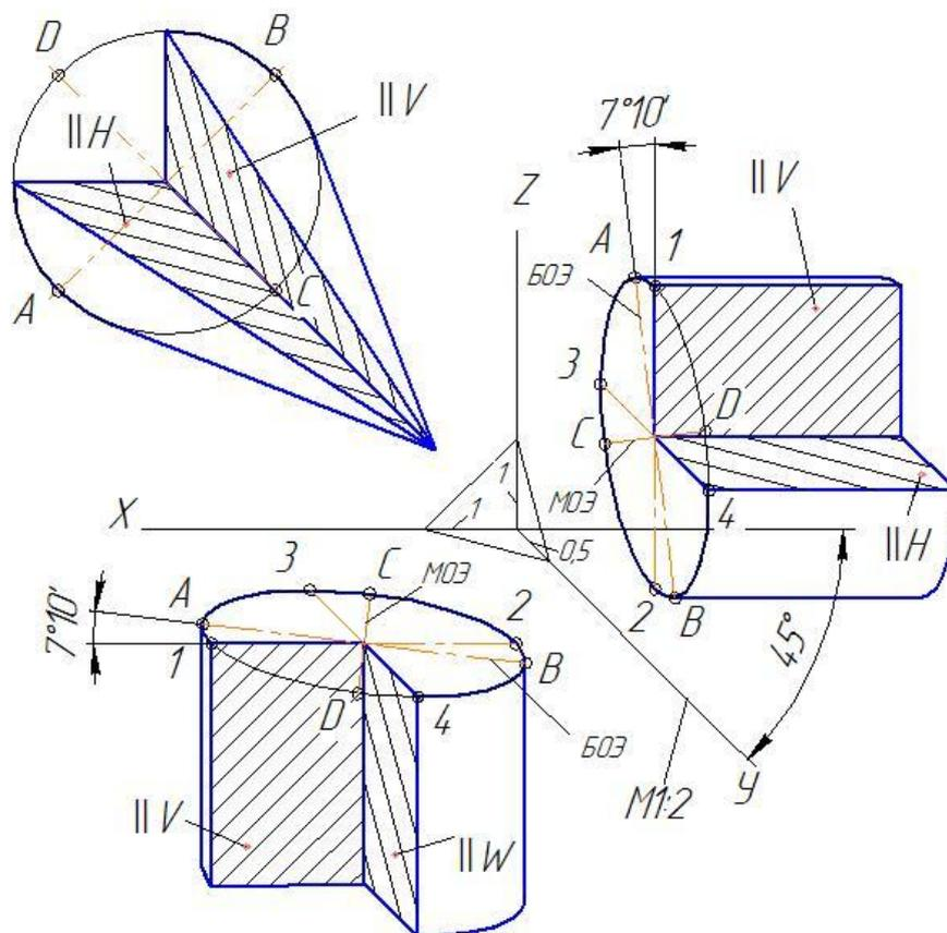
1 БОЭ – большая ось эллипса. На горизонтальной и на профильной плоскости проекций  $AB = 1,06d$ , МОЭ – малая ось эллипса. На горизонтальной и на профильной плоскости проекции  $CD = 0,33d$ , отрезок  $1 - 2 = d$ , отрезок  $3 - 4 = 0,5d$ , где  $d$  – диаметр цилиндра. На фронтальной плоскости проекций оси проецируются без искажения.
