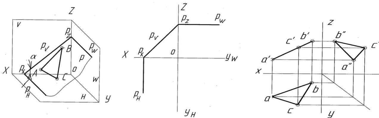
Рисунок 3.6 – Наглядное изображение и эюр фронтально проецирующей плоскости
