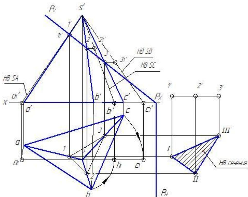
Рисунок 5.1 — Пример построения проекции сечения пирамиды фронтально проецирующей плоскостью. Определение натуральной величины фигуры сечения
