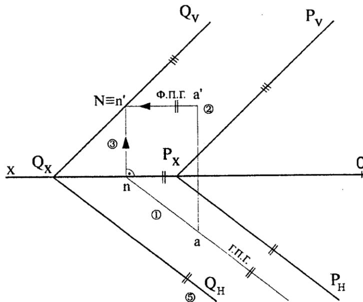
Рисунок 3.24 – Пример построения плоскости  $Q$ , проходящей через точку  $A$  параллельно заданной плоскости  $P$
