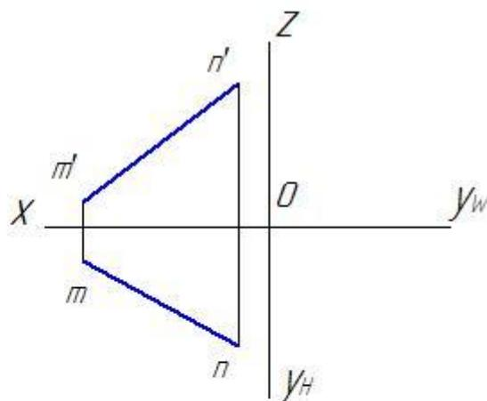
2.6 Определить натуральную величину и углы наклона к плоскости проекций отрезка прямой  $MN$ .
