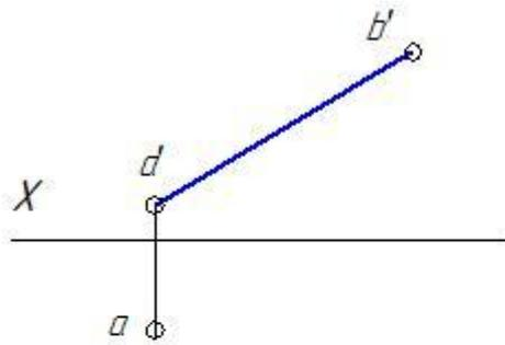
2.7 Дана фронтальная проекция отрезка  $AB$  и горизонтальная проекция точки  $A$ . Построить горизонтальную проекцию  $AB$ , если его длина равна 50 мм.
