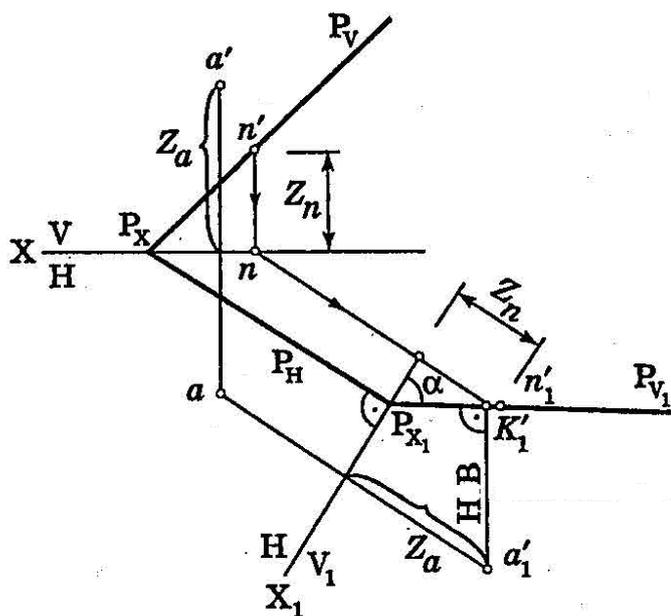
Рисунок 4.4 – Определение расстояния от точки  $A$  до плоскости  $P$
