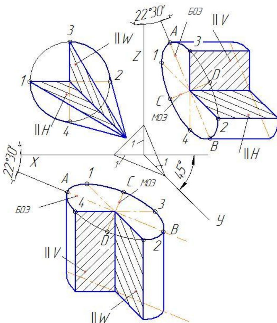
1 БОЭ – большая ось эллипса. На горизонтальной и на профильной плоскости проекций  $AB = 1,33d$ , МОЭ – малая ось эллипса. На горизонтальной и на профильной плоскости проекций  $CD = 0,54d$ , отрезок  $1 - 2 = d$ , отрезок  $3 - 4 = d$ , где  $d$  – диаметр цилиндра. На фронтальной плоскости проекций оси проецируются без искажения.
