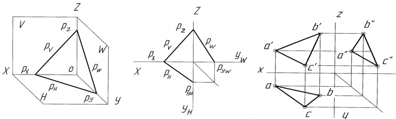
Рисунок 3.4 – Наглядное изображение плоскости общего положения и ее эпюра
