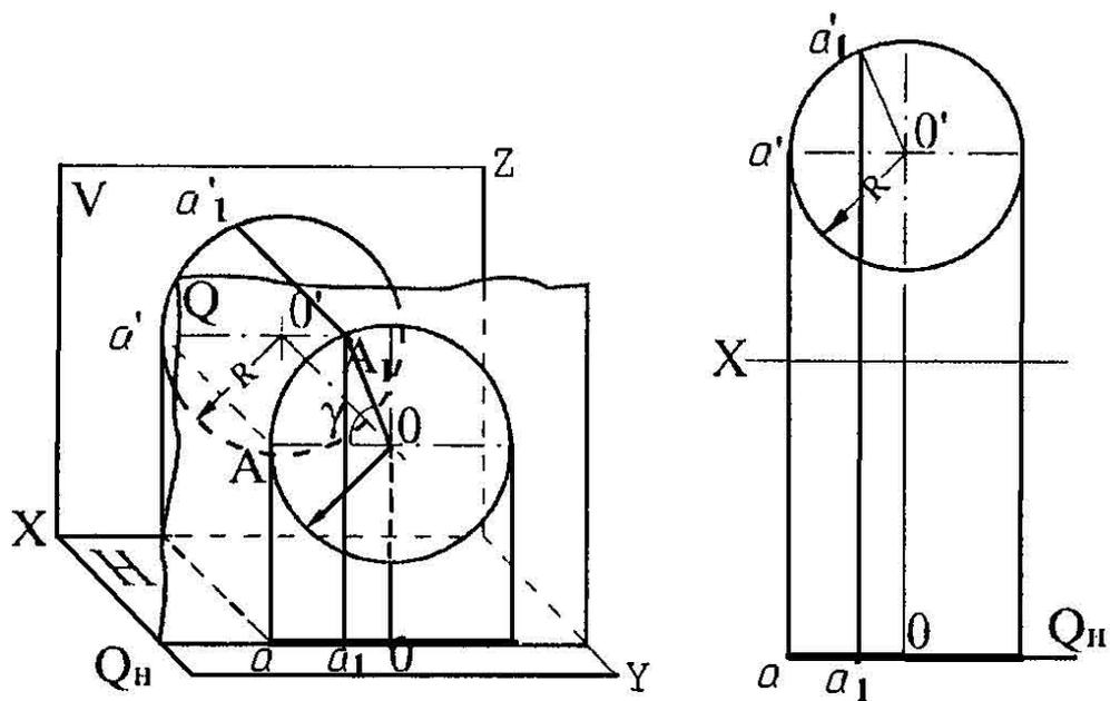
Рисунок 4.6 – Вращение точки  $A$  вокруг фронтально проецирующей оси
