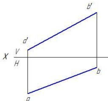
4.2 Преобразовать плоскости проекций так, чтобы отрезок  $AB$  занял положение перпендикулярное к новой плоскости  $H_1$ .
