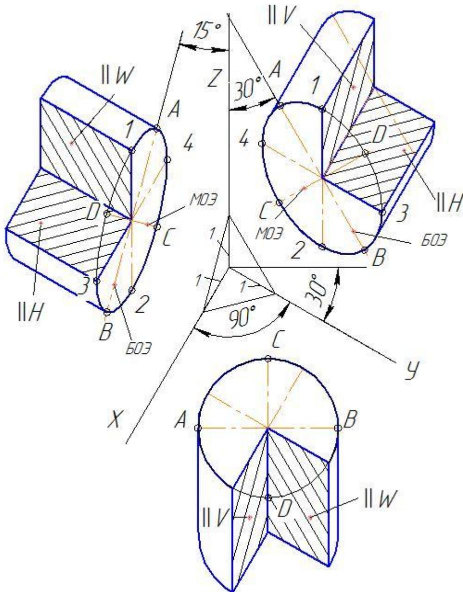
1 БОЭ – большая ось эллипса. На фронтальной плоскости проекций  $AB = 1,37d$ , МОЭ – малая ось эллипса. На фронтальной плоскости проекций  $CD = 0,37d$ , отрезок  $1 - 2 = d$ , отрезок  $3 - 4 = d$ , на профильной плоскости проекций  $AB = 1,22d$ ,  $CD = 0,71d$ , отрезок  $1 - 2 = d$ , отрезок  $3 - 4 = d$ , где  $d$  – диаметр цилиндра. На горизонтальной плоскости проекций оси проецируются без искажения.
