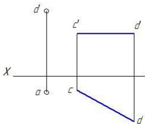
2.9 Через точку  $A$  провести отрезок прямой длиной 30 мм, параллельной данной прямой  $CD$ .
