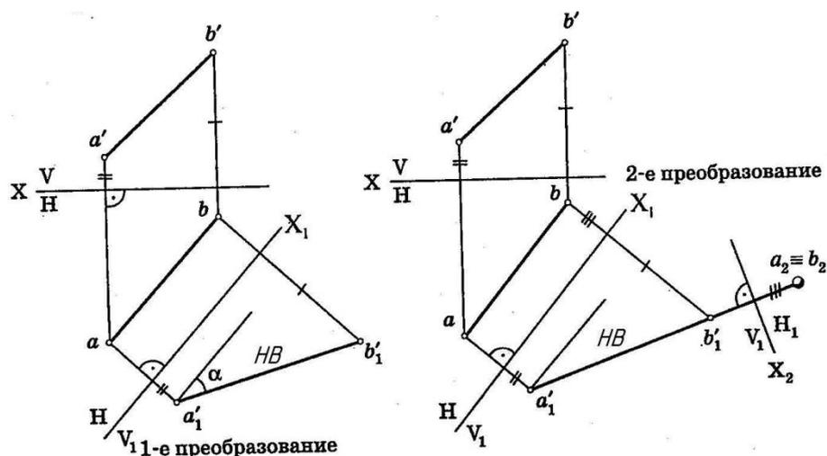
Рисунок 4.2 – Преобразование прямой общего положения в проецирующую способом перемены плоскостей проекций
