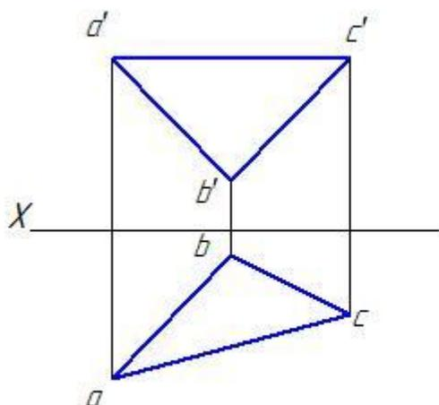
4.8 Определить угол наклона плоскости  $ABC$  к  $V$ .
