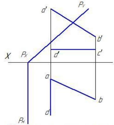
3.9 Достроить проекцию фигуры  $ABCD$  и построить линию пересечения плоскостей.
