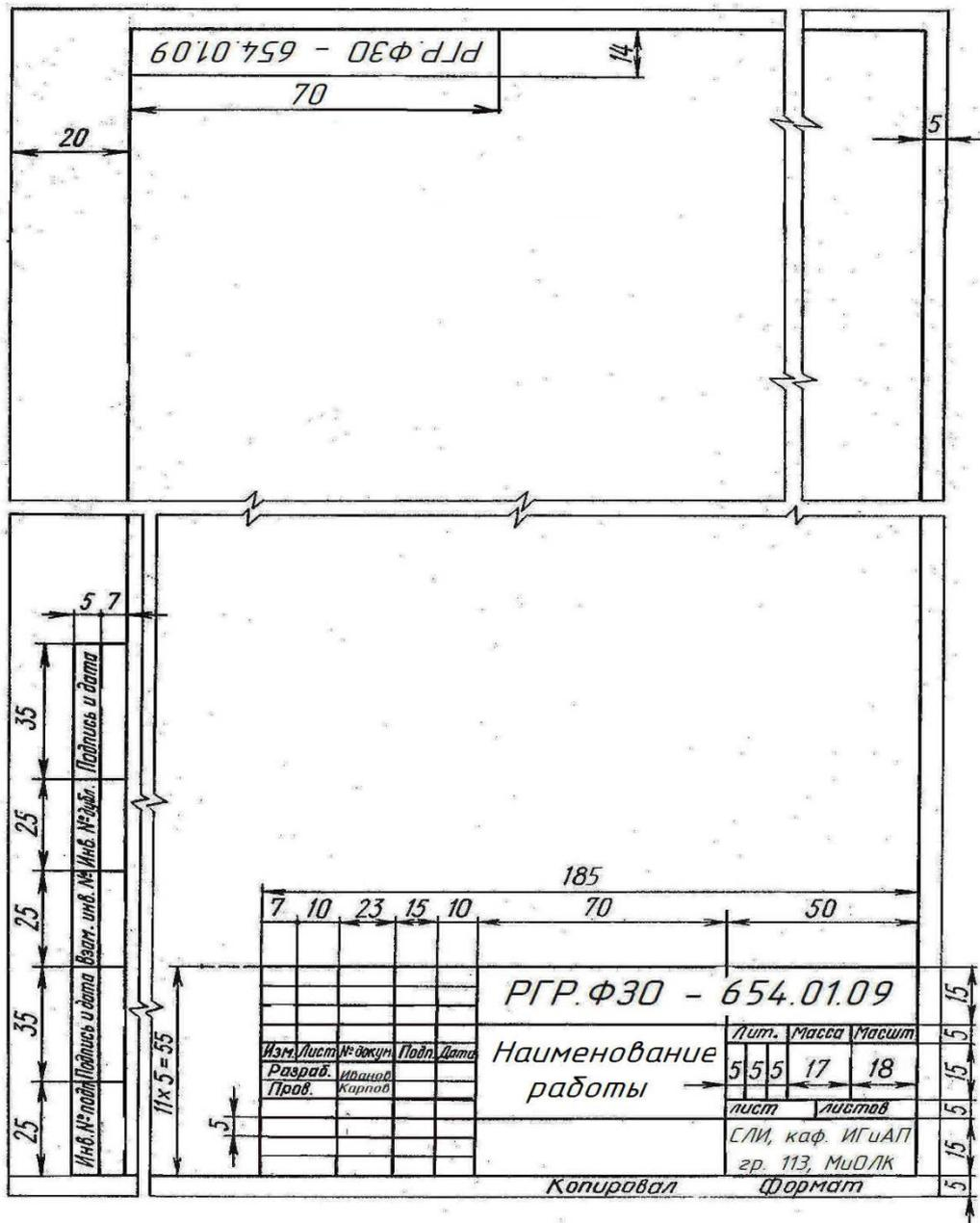
Рисунок 3 – Формат чертежного листа А3, А2, А1 при их горизонтальном расположении.
