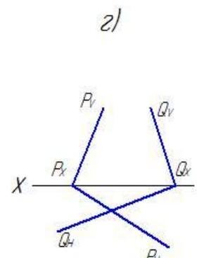
3.12 (а-г) Построить проекции линии пересечения данных плоскостей
