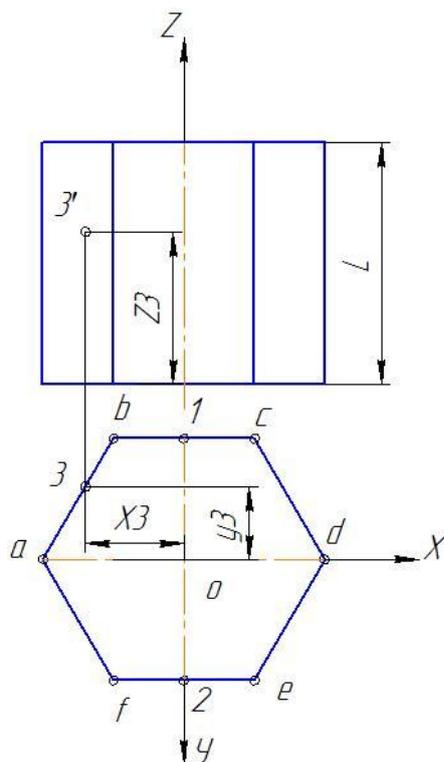
Рисунок 6.1 – Ортогональный чертеж шестигранной призмы
