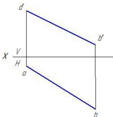
4.1 Определить натуральную величину отрезка  $AB$  и углы наклона его к плоскостям проекций.
