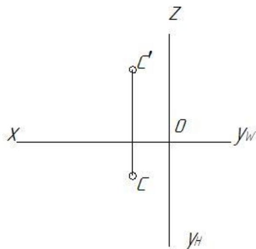
2.4 Через точку  $C$  провести профильную прямую под углом  $30^\circ$  к  $V$  и пересекающую плоскость  $H$ .
