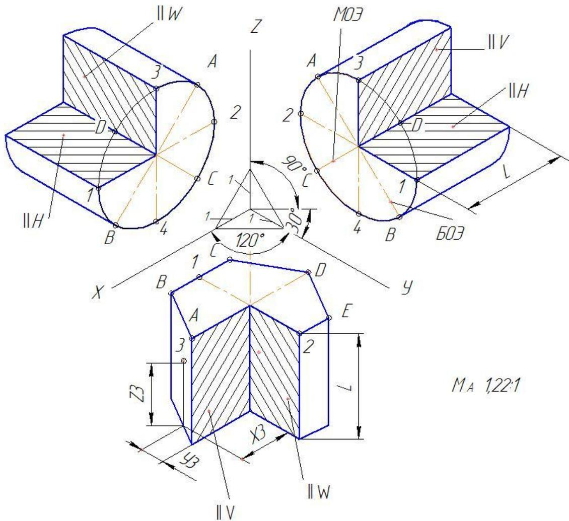
1 БОЭ – большая ось эллипса  $AB = 1,22d$ , МОЭ – малая ось эллипса  $CD = 0,71d$ , отрезок  $1 - 2 = d$ , отрезок  $3 - 4 = d$ , где  $d$  – диаметр цилиндра.
