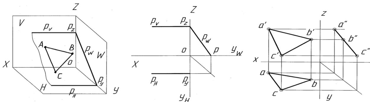
Рисунок 3.7 – Наглядное изображение и эпюр профильно проецирующей плоскости
