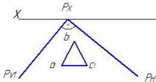
4.18 По совмещенному положению с плоскостью  $h$  построить проекции равностороннего треугольника  $ABC$ , лежащего в плоскости  $P$
