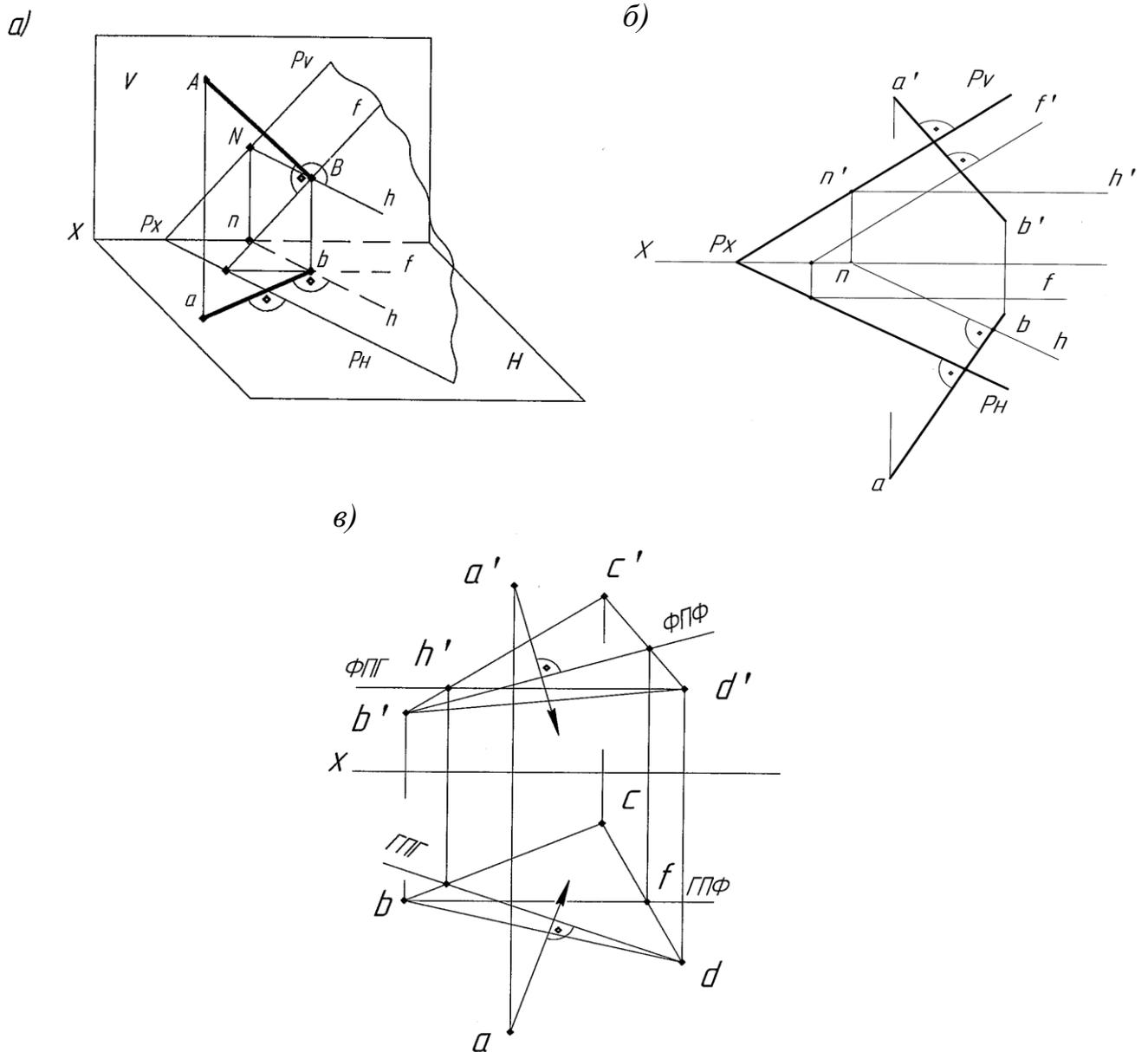
Рисунок 3.17 – Проведение перпендикуляра из точки  $A$  к плоскости
