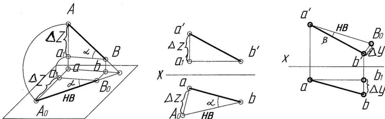
$\alpha$  – угол наклона прямой  $AB$  к горизонтальной плоскости проекций;  $\beta$  – угол наклона прямой  $AB$  к фронтальной плоскости проекций.
