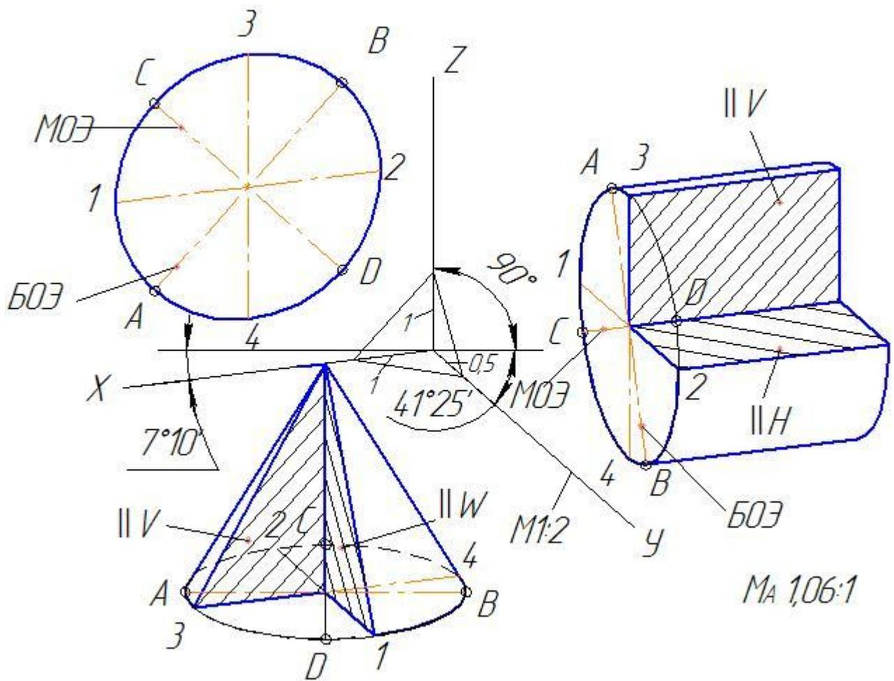
1 БОЭ – большая ось эллипса. На горизонтальной и на профильной плоскости проекций  $AB = 1,06d$ , МОЭ – малая ось эллипса. На горизонтальной и на профильной плоскости проекций  $CD = 0,35d$ , отрезок  $1-2 = 0,5d$ , отрезок  $3-4 = d$ . На фронтальной плоскости проекций  $AB = 1,06d$ ,  $CD = 0,95d$ , отрезок  $1-2 = d$ , отрезок  $3-4 = d$ , где  $d$  – диаметр цилиндра.
