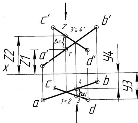
Рисунок 2.10 – Эпюр скрещивающихся прямых и определение видимости с помощью конкурирующих точек
