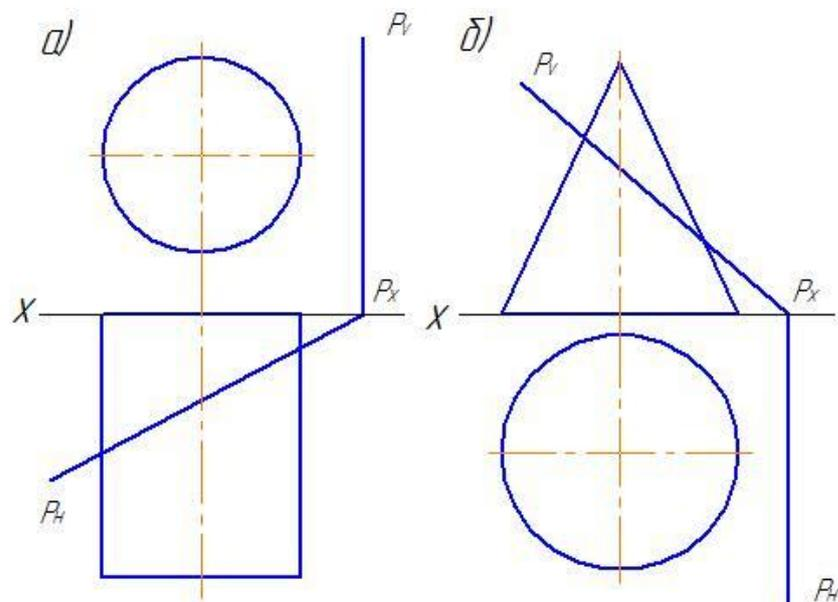
55 (а-б) Построить три проекции линии пересечения поверхностей вращения плоскостью  $P$ , определить натуральную величину фигуры сечения и выполнить развертки отсеченной части каждой поверхности
