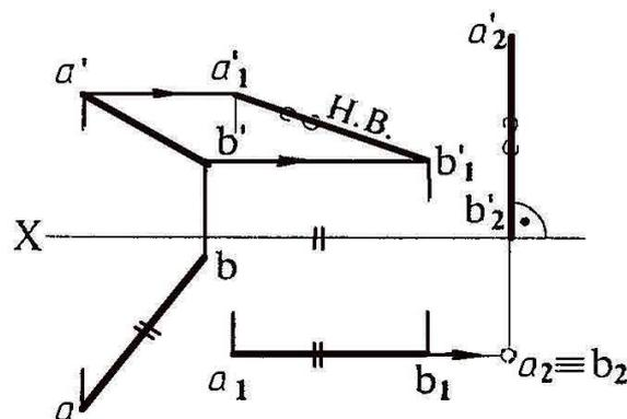
Рисунок 4.7 – Преобразование отрезка  $AB$  прямой общего положения
