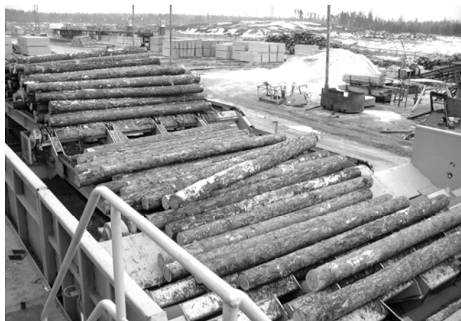
Рис. 3.1. Устройство поштучной выдачи пиловочника КСП-10 [18]: внешний вид
