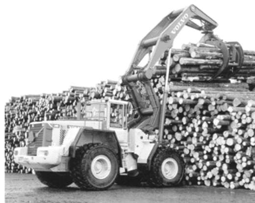
Рис. 2.30. Работа челюстного автопогрузчика [28]
