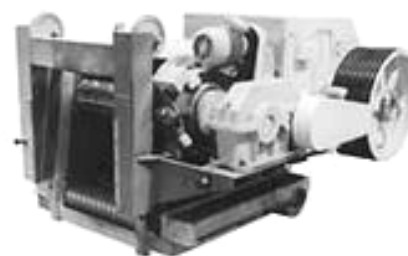
Рис. 3.38. Рубительная машина барабанная ножевая МРБ4-30ГН [27]
