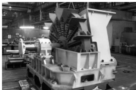
Рис. 3.18. Дисковая ножевая рубительная машина МР7-300А [27]
