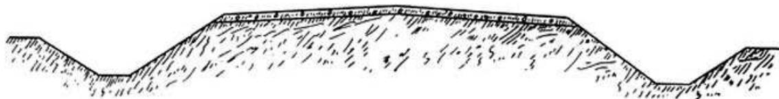
Рис.2. Поперечный профиль грунтовых дорог во второй половине XIX в.
