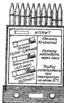
Рис. 4.3. – Кассета с индикаторными трубками
