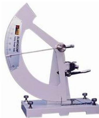
Рисунок 15 — Прибор типа Р-1 по методу Эльмендорфа
