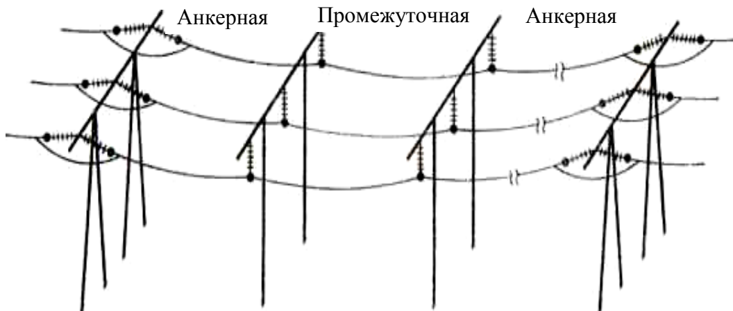
Рис. 44. Общий вид воздушной линии электропередачи
